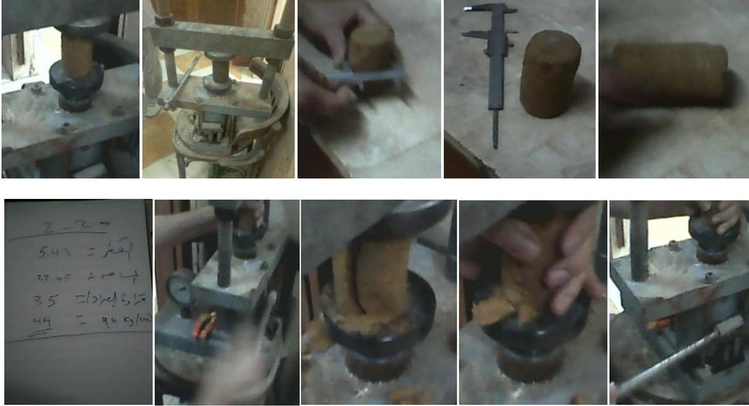
هذا الاختبار لتحديد قوة قص التربة
