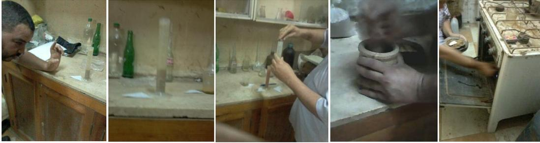
من الاختبارات السهلة التي يمكن من خلالها تحديد الانتفاخ الحر Free-Swell Test للتربة عن طريق وضع (10)سم3 من التربة الجافة المارة من خلال منخل رقم (40) ببطء شديد إلى إناء مدرج لـ ( 100)سم3 وملئه بالماء وملاحظة حجم التربة حتى يثبت ، ويتم تحديد مقدار الانتفاخ بالمعادلة التالية :
