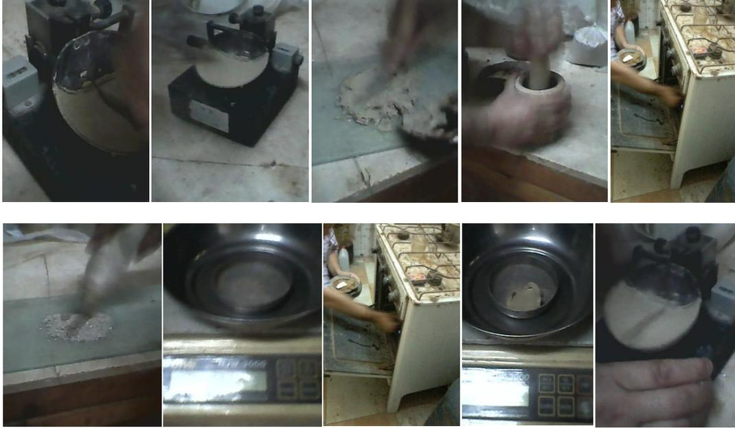
حد السيولة هو اقل كمية مياه تكون بعينة التربة بحيث لو قلت عن هذا الحد تتحول الى حالة اللدونه او هو الحد الفاصل بين حالة السيولة و حالة اللدونه فى التربة.
