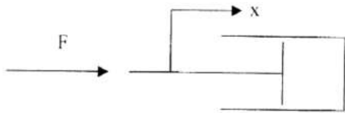
شكل رقم (1.11) مخمد أو مضائل اهتزاز
