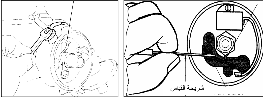
شكل ٥ - ٢ طريقة وزن الخلوص بين نقاط التلامس باستعمال شريحة القياس.
