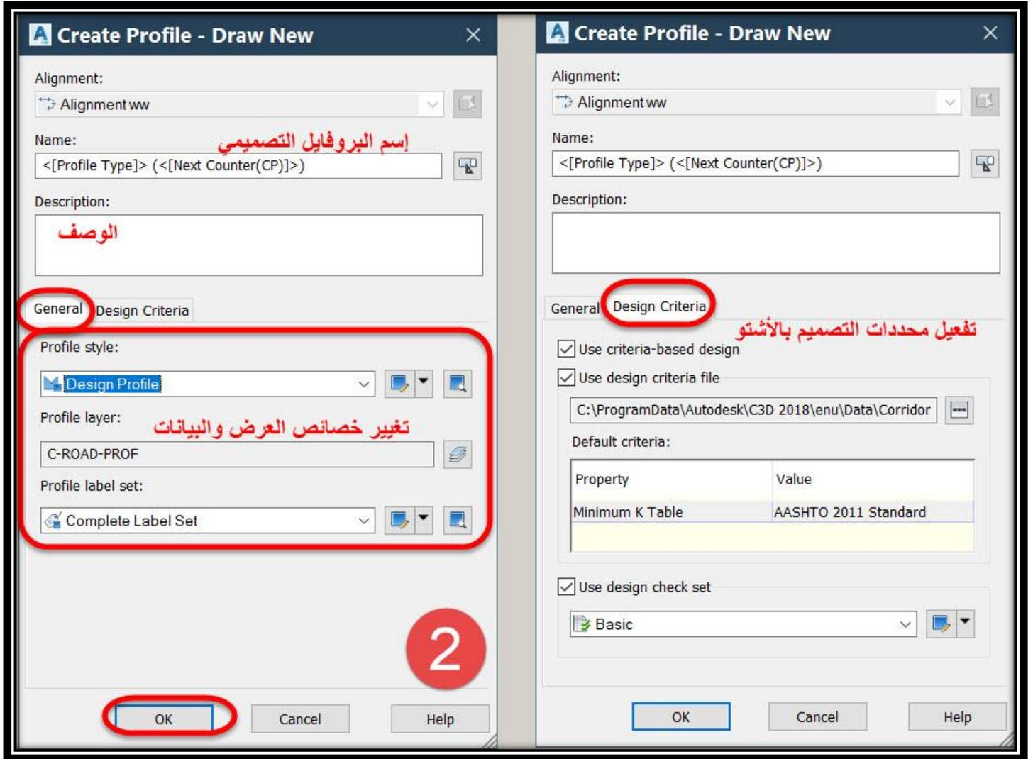
3. ومن هذه النافذة (والتي تشبه نافذة Alignment) نختار طريقة رسم خط البروفايل التصميمي وليكن **Draw Tangents With Curve** أي رسم الخط التصميمي بمنحنيات رأسية .
