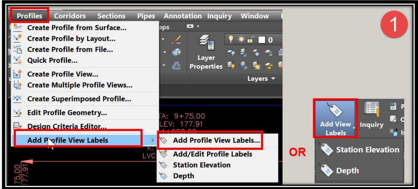
2. Station Elevation يعطي المنسوب و المحطة عند النقطة التي يتم إختيارها في أي مكان
