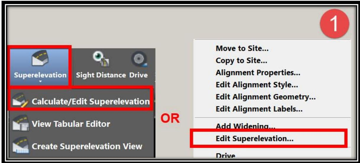
2. ومن هذه النافذة يمكننا تعديل كافة المحددات التصميمية أو إختيار **Superelevation Wizard**
