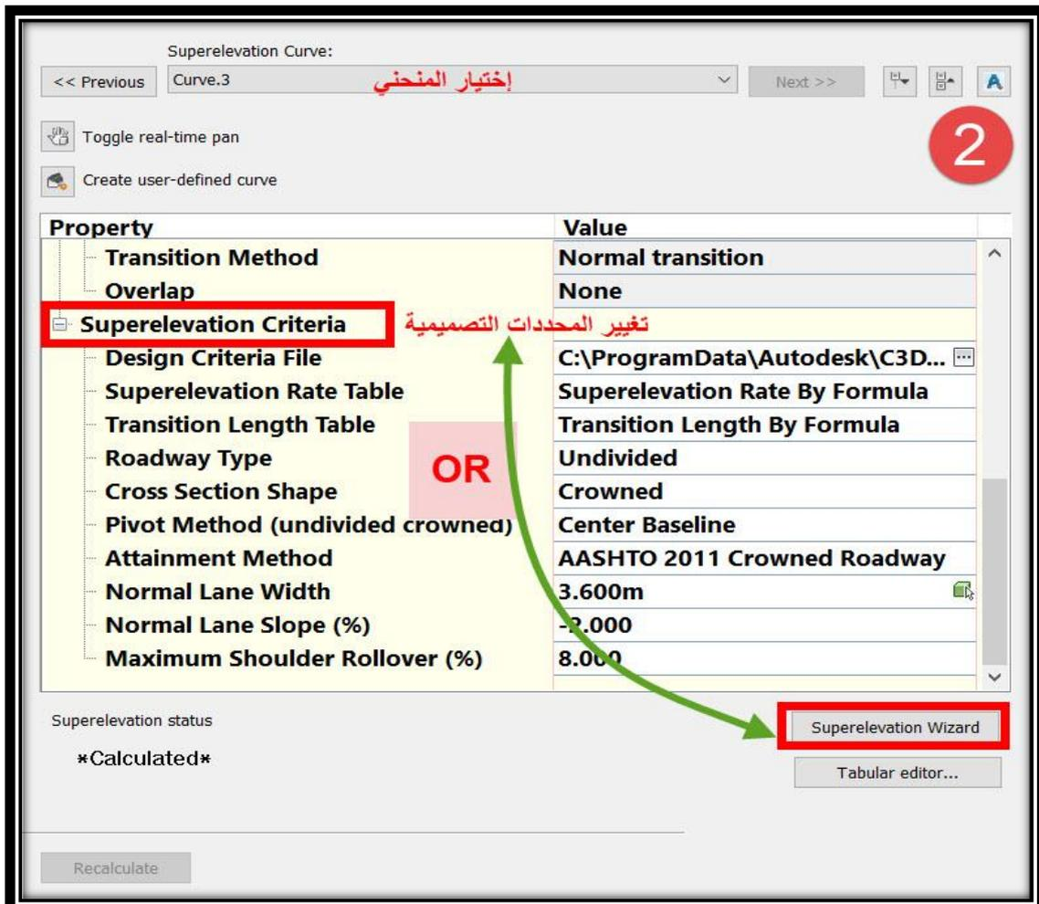
3. وعند الضغط علي **Superelevation Wizard** تظهر نافذة لإختيار المنحنيات المراد تغييرها ويتم إختيار كامل المسار ثم **OK** ثم تظهر نفس القائمة التي ظهرت لنا في البداية كما سبق شرحه .
