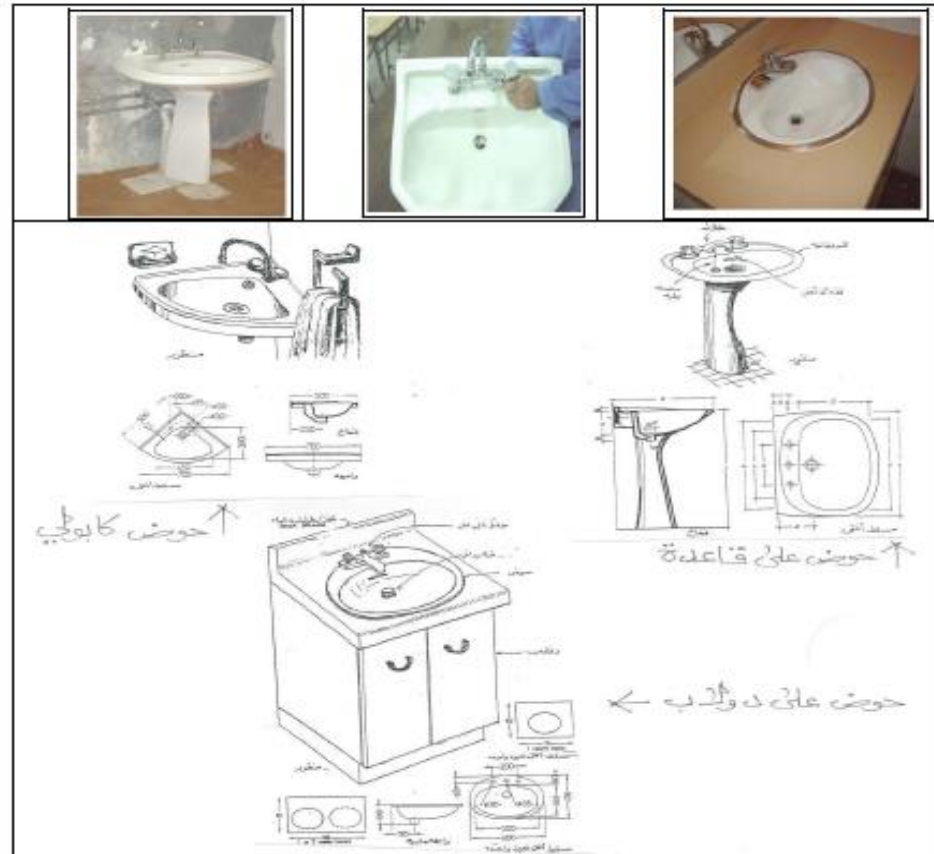
شكل يوضح المقاسات والتفاصيل الخاصة بأنواع الأحواض ( المغاسل ) من حيث طرق تثبيتها
