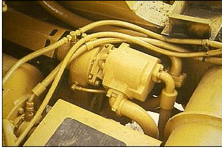
الشكل رقم (٢٩) : دائرة الهيدروليك في القلابات الضخمة
