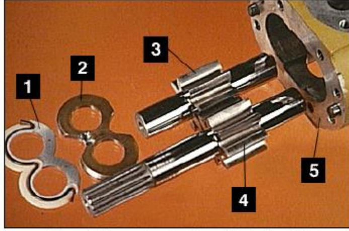
الشكل رقم (٢٦) : مكونات المضخة الترسية
