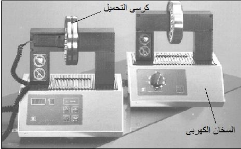
الشكل رقم (١٢): طريقة التسخين بالسخان الكهربائي
