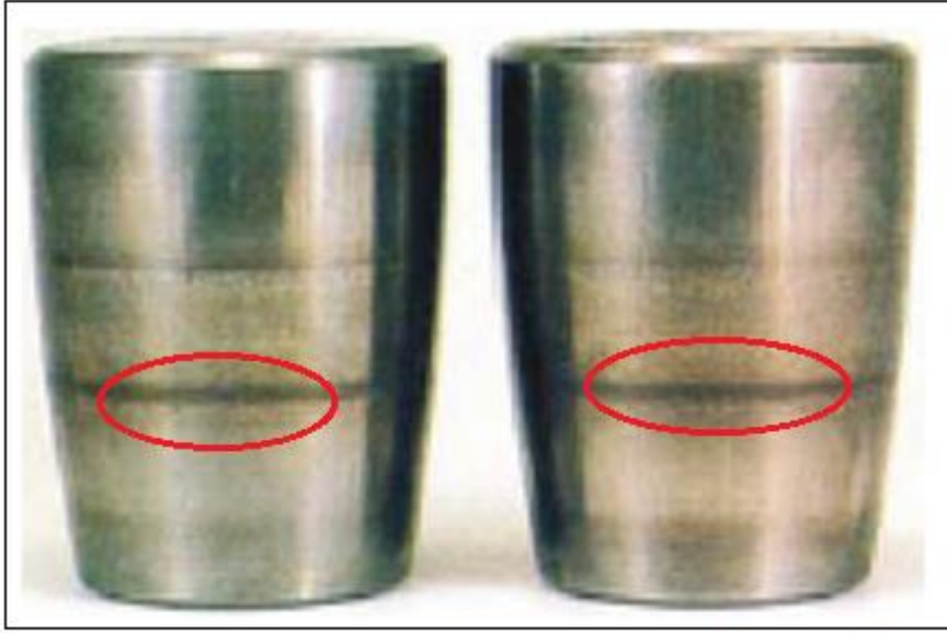
الشكل رقم (١٦) : خشونة سطح الكريات نتيجة تكون القشارة
