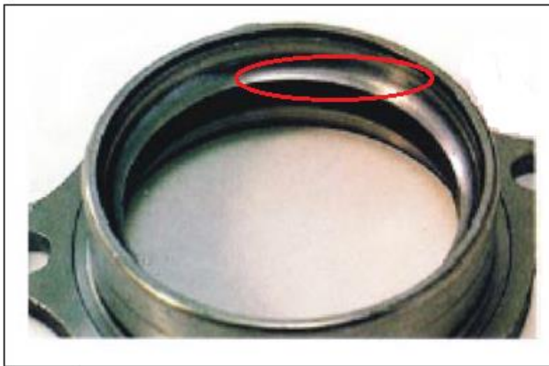
الشكل رقم (١٧) : التآكل الداخلي في كرسي التحميل نتيجة الاحتكاك
