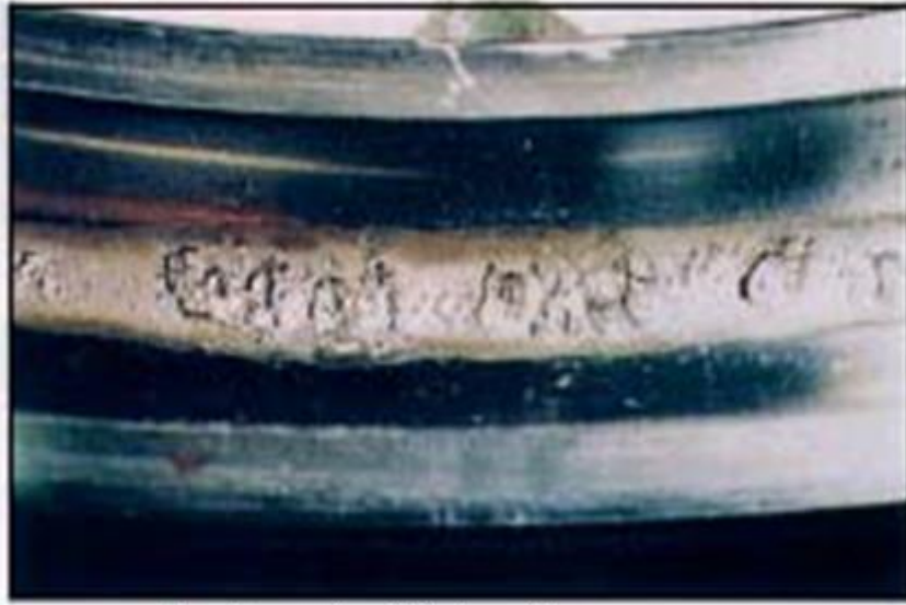
الشكل رقم (١٥) : التقشر الرقائقي بكرسي التحميل
