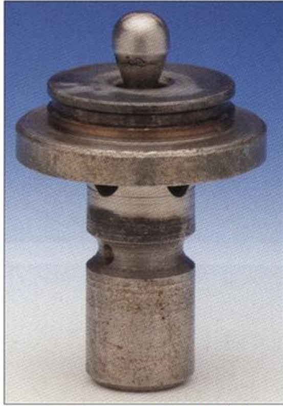
تآكل في قلب صمام تصريف الضغط
