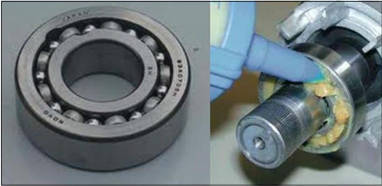
الشكل رقم (١٤) : طريقة تشحيم كراسي التحميل
