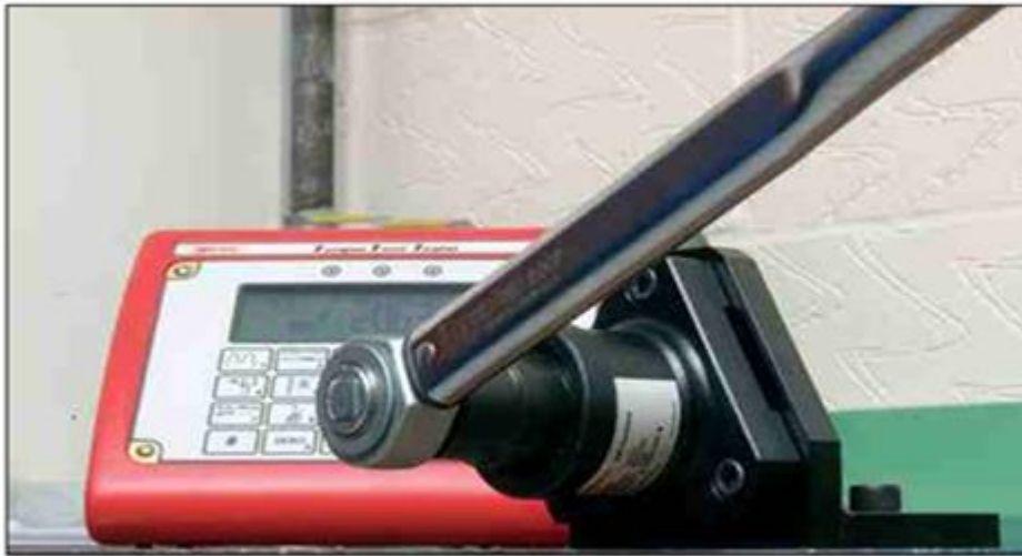
الشكل رقم (٩٤) : طريقة استخدام مفتاح العزم
