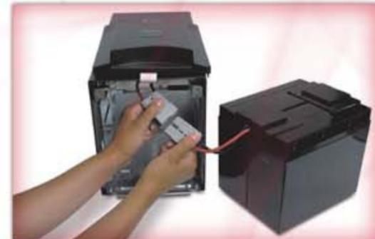
هناك من يقومون بعمل تعديلات على جهاز الـ UPS بغرض زيادة المدة الزمنية لفترات طويلة بعد انقطاع الكهرباء , عن طريق ازالة أو فصل البطاريات الداخلية وتوصيل بدلا منها بطارية سيارة 12 فولت وبوجود شاحن خاص لها ويعمل الحاسوب بهذه الطريقة من 5 - 10 ساعات حسب استطاعة البطارية وقوتها .
