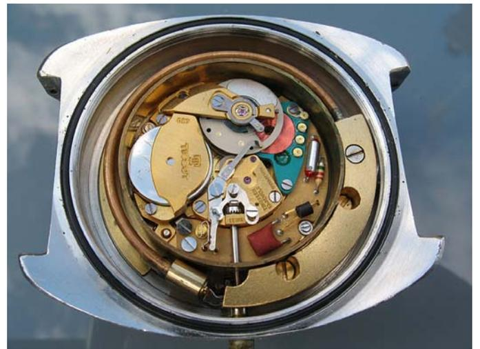
ساعة غوص تستخدم أنبوب بوردن **Bourdon Tube** بداخلها لقياس العمق **Depth**
