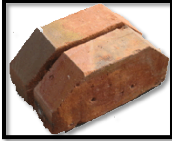
الطوب الاحمر الصنوع ميكانيكيا ( قطع السلك ) .
