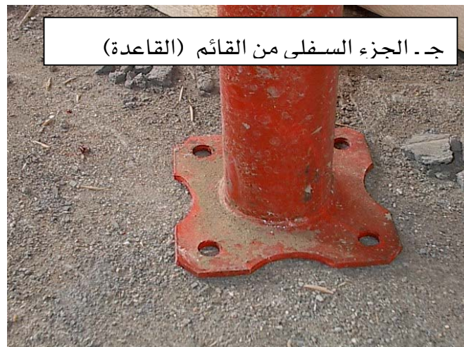
شكل رقم (٧٩) أجزاء الدعائم المعدنية
