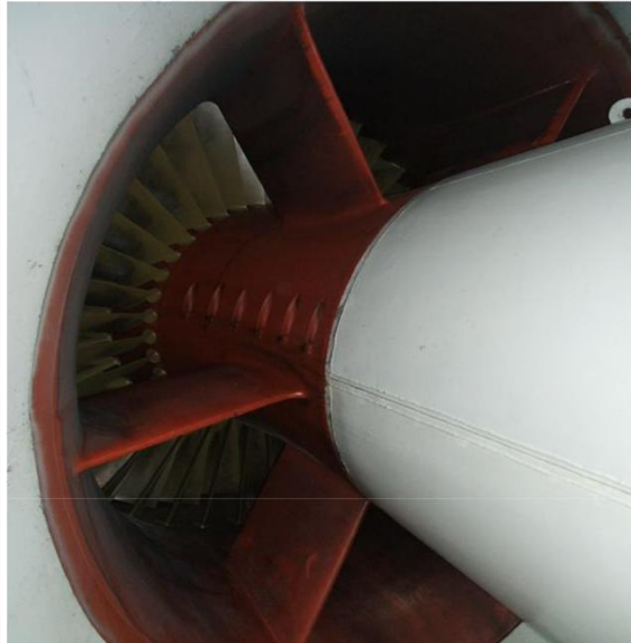
الشكل ( ٥٥ ) ريش التوجيه المتغيرة لمداخل الضاغط Compressor variable inlet guide vanes (I.G.V)
