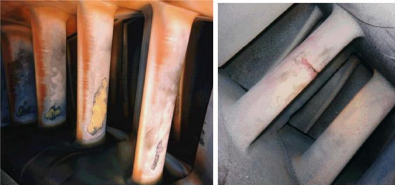
الشكل ( ١٢٥ ) المرحلة الأولى من الريش الثابتة للتوربين الغازي تعاني من الناكل والتعرية
