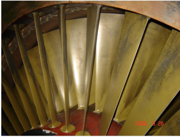
الشكل ( ٥٥ ) ريش التوجيه المتغيرة لمداخل الضاغط Compressor variable inlet guide vanes (I.G.V)
