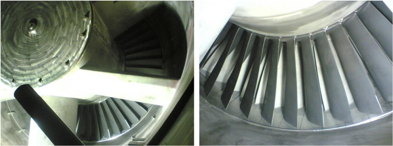
الشكل ( ١١٠ ) الحلقات الكربونية لريش ومحامل التوربين مركبة في الجزء الثابت من التوربين Gas turbine blades & bearing carbon rings fitted in stator
