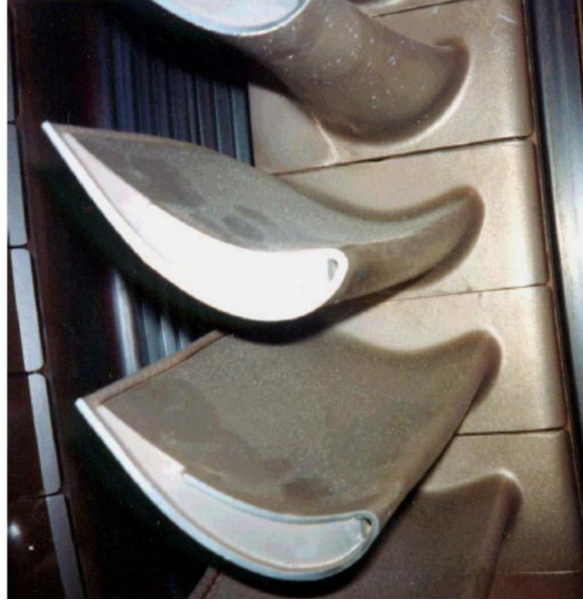
الشكل ( ١١٣ ) المرحلة الأولى من الريش المتحركة للتوربين الغازي Gas turbine first stage moving blade
