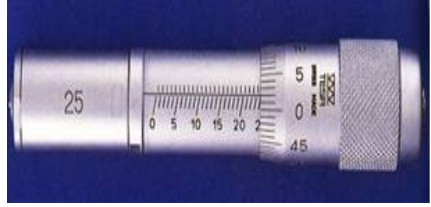
(أ) ميكرومتر قياس داخلي طوله الصفري 25 مم.
