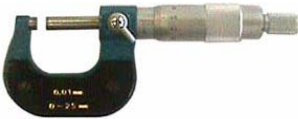
الشكل (15-1): تصميمات مختلفة من ميكرومترات القياس الخارجي.
