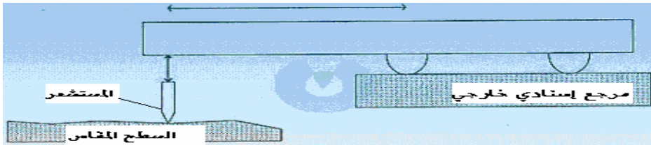
الشكل (4-5): المبدأ الأساسي لطريقة قياس التفاوتات الهندسية.
