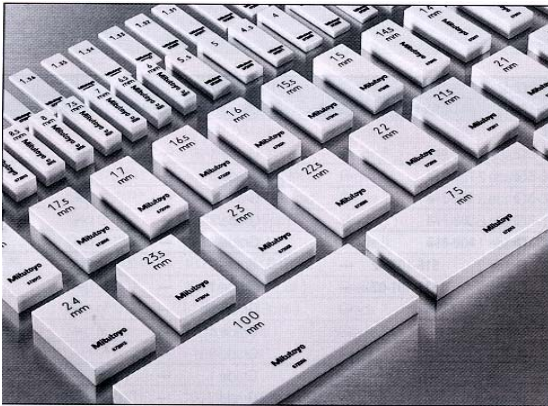
الشكل (21-1): مجموعة قوالب قياس متوازية ذات مقطع مستطيل مصنوعة من السيراميك.
