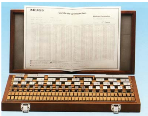
الشكل (1-20): مجموعة قوالب قياس متوازية ذات مقطع مربع مصنوعة من الفولاذ.
