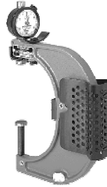
الشكل (3-15): محددات القياس الفكّية القابلة للضبط ذات مبين بمؤشر أو رقمية
