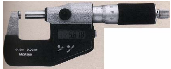
الشكل (15-1): تصميمات مختلفة من ميكرومترات القياس الخارجي.
