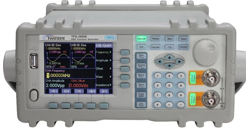
الشكل (1-22) الجهاز مولد الذبذبات (النبضات) Function generator
