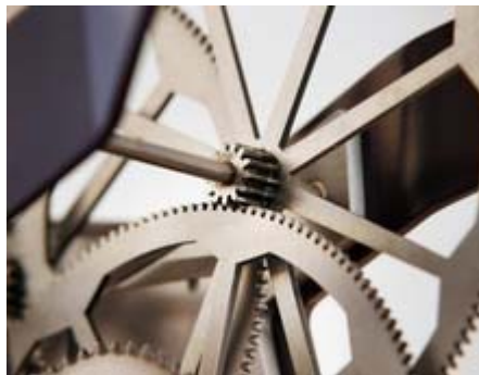
مجموعة من التروس الداخلية متصلة بمولد تعمل علي تحويل حركة سقوط الثقل إلي كهرباء
