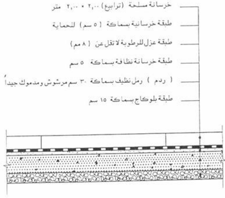
أ- قطاع رأسي لأرضية موقف بالقبو أو بالدور الأرضي شكل رقم (١٨-أ)
