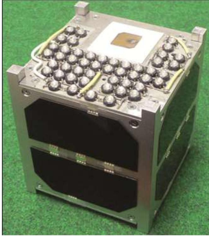
القمر **FITSAT** ، أحد الأقمار الصناعية الصغيرة التي تك دفعها في المدار بواسطة نظام وحدة مناولة التجارب اليابانية الروبوتية.
