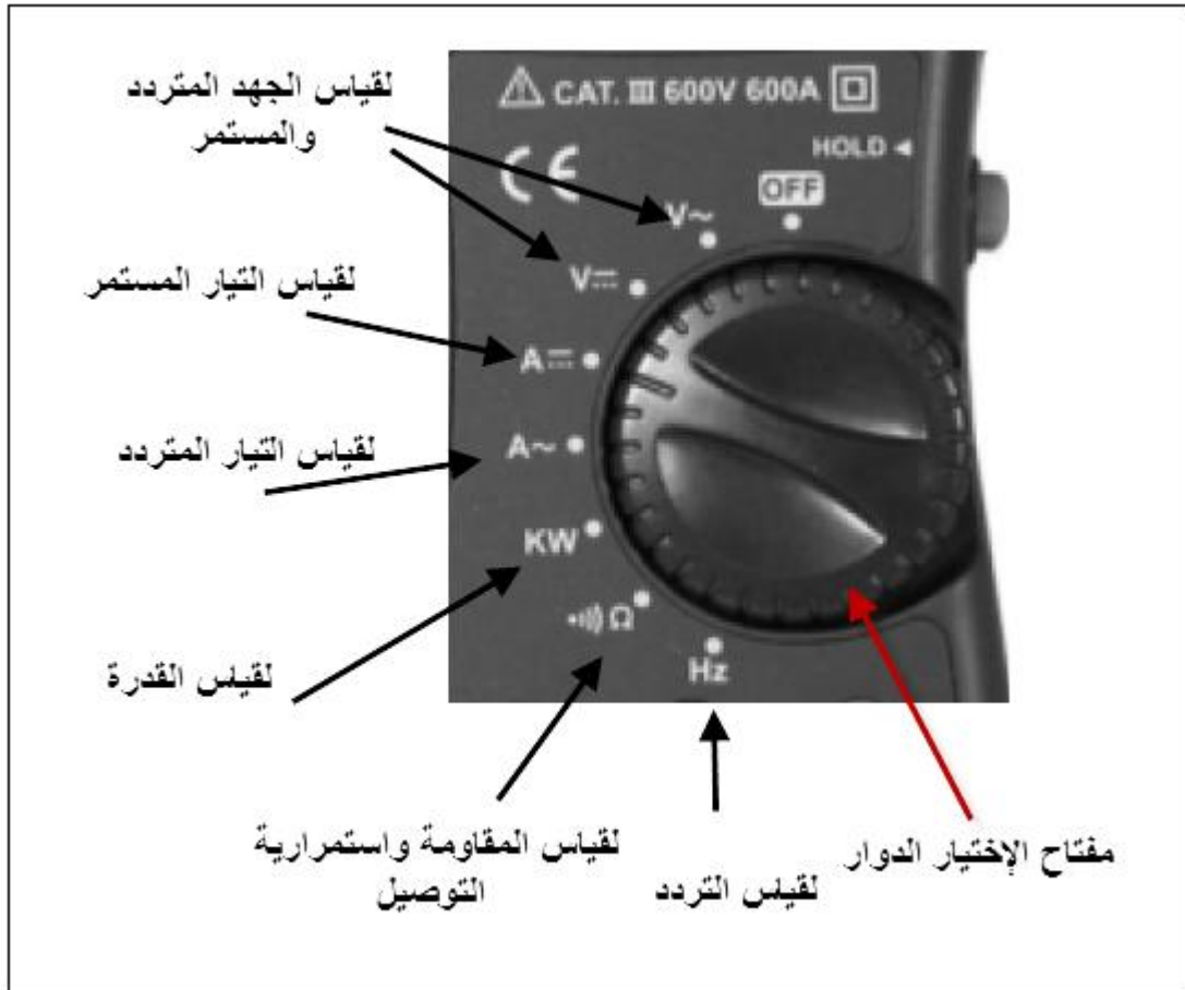
الشكل رقم (١٨) : المفتاح الدوار موضحا به بياناته المختلفة
