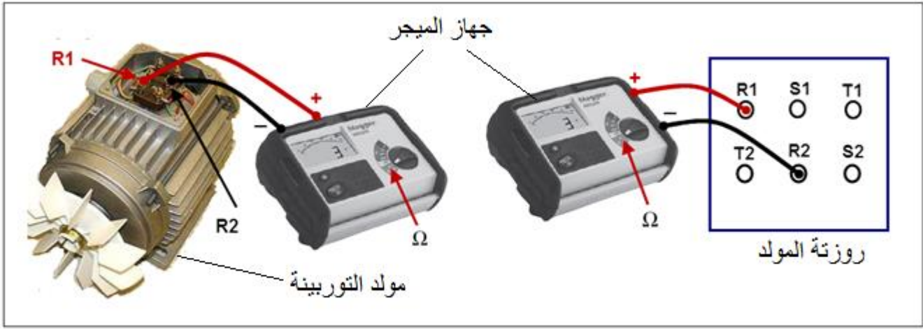
الشكل رقم (١٤): قياس استمرارية التوصيل في مولد التوربينة باستخدام الميجر
