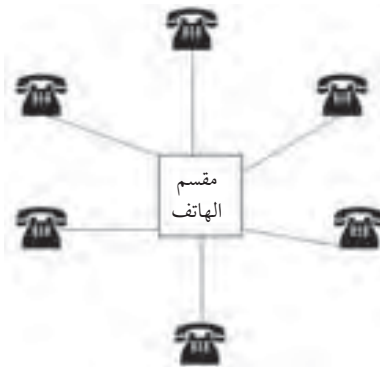
شكل (3) : مقسم الهاتف
