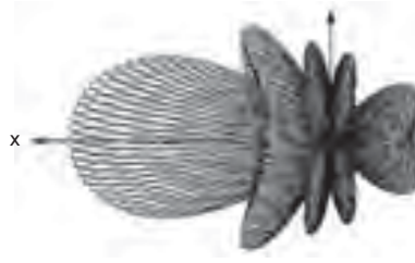
الشكل (٢٤): هوائي ياغي ومخطط إشعاعه
