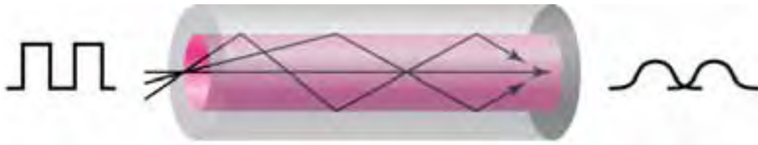
شكل (٣٢) : مسار الشعاع في الليف البصري ذي النمط المتعدد ومعامل الانكسار الخطوي
