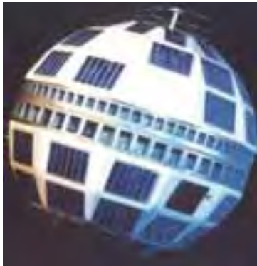
شكل (٢٨): قمر صناعي تل ستار (Telstar)
