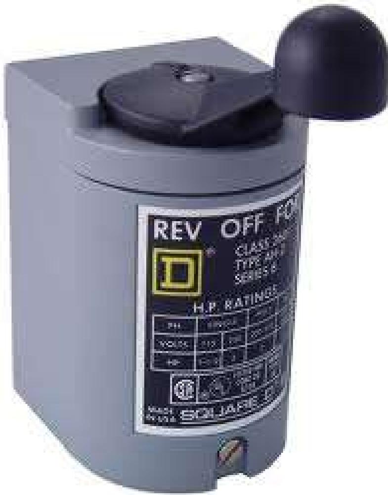
حيث يعمل المفتاح على تغيير اتجاه دوران المجال المغناطيسي للعضو الساكن ولتحقيق هذا الغرض يجب تغيير تسلسل الأطوار في ملفات العضو الساكن في المحرك الكهربائي وذلك بتغيير تسلسل توصيل تلك الأطوار أي بتبديل وضع طورين
