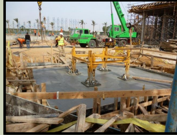
اختبار للقواعد المسلحة
