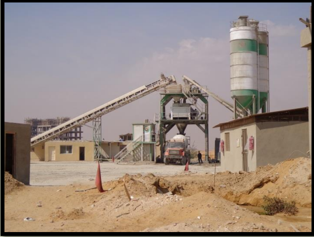
طريقة تعبئة العربات بالخرسانة الجاهزة
