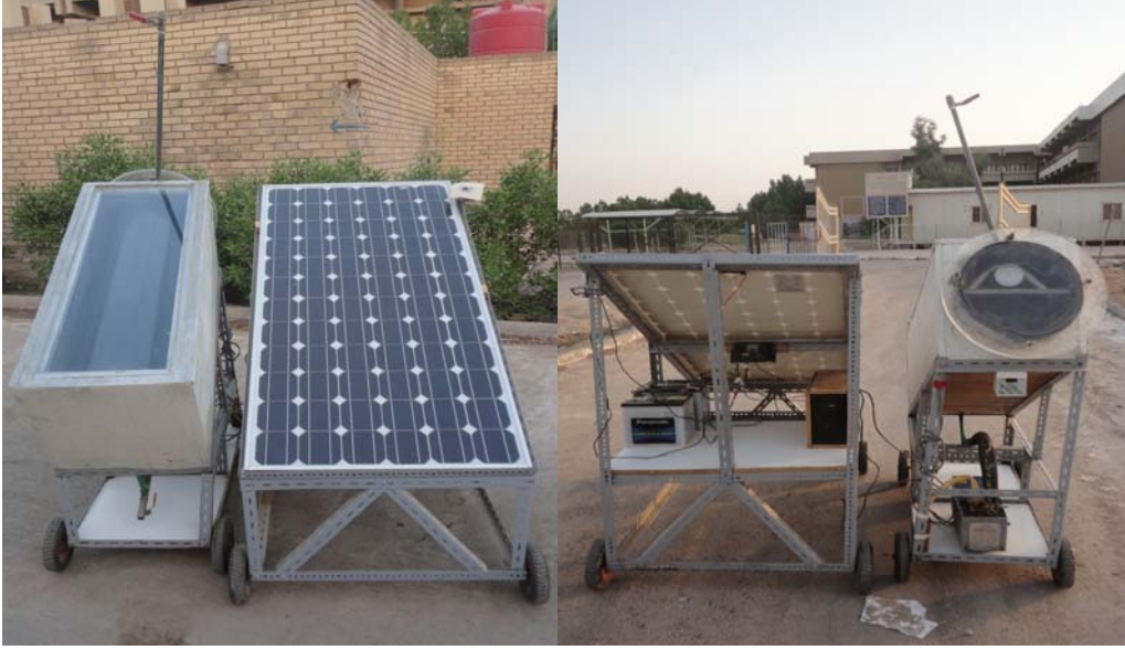
شكل (2) : صورتان فوتوغرافيتان للمجفف الشمسي تحت التفريغ من الأمام والخلف
