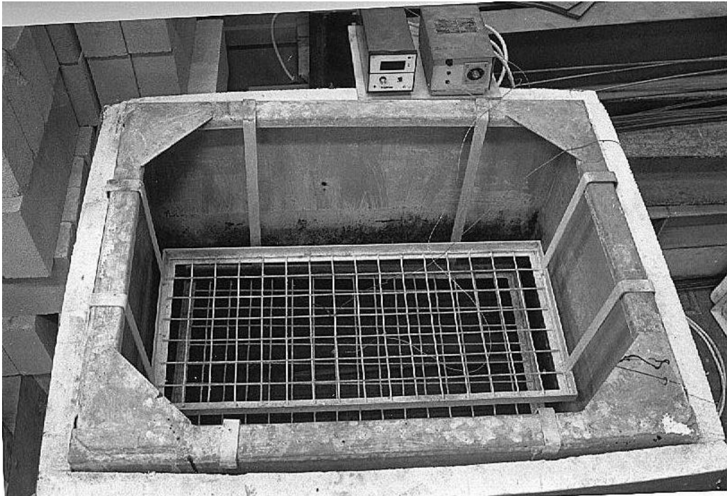
شكل رقم ٥,٣: خزان للعينات الخرسانية المعالجة بالبخار
