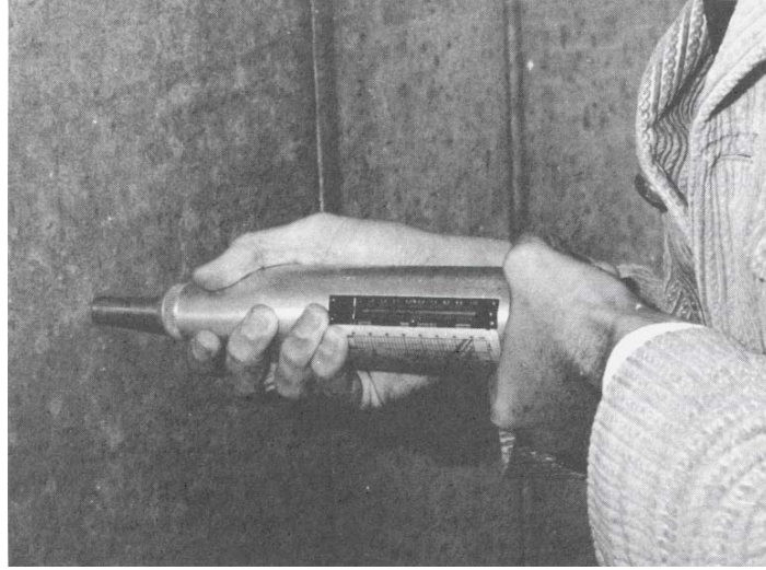
شكل رقم ١٠,٧ : وضع جهاز مطرقة شميدت عمودي على سطح الخرسانة.
