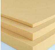
وهي مادة عضوية تمتاز بأن لها معامل توصيل حراري منخفض جداً وقليلة امتصاص الماء أو بخار الماء كما أنها خفيفة الوزن ومقاومة للانضغاط وتأتي بصورة ألواح جاهزة أو رش، والبولي يوريثين شائع الاستعمال كعازل حراري وخاصة في عزل الأسقف.
