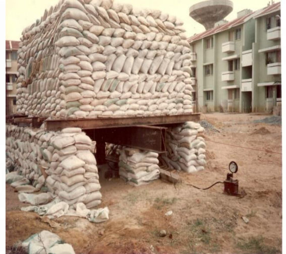
شكل رقم (٤-٣١) : تجربة إختبار حمل رأسى ضاغط على خازوق مفرد
