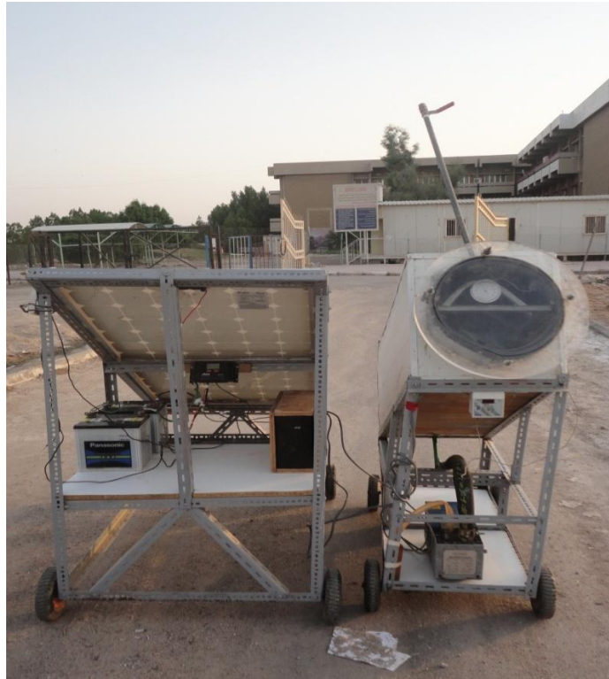
شكل ( 1 ) : صورتان فوتوغرافيتان للمجفف الشمسي تحت التفريغ من الأمام والخلف
