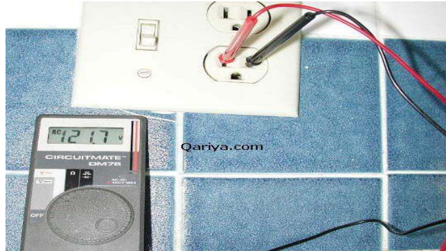
شكل ( 4-4 ) يبين وضع عملي لقياس الجهد الكهربى لمأخذ تيار ( بريزة ) تيار متردد
