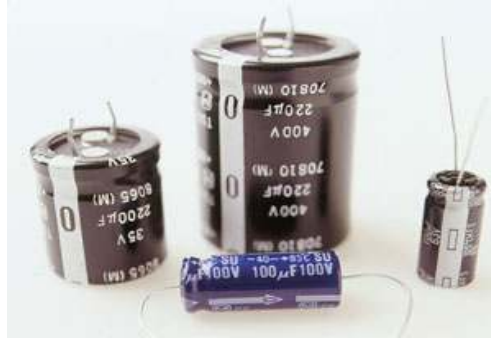
شكل ( 5-8 ) بعض أشكال المكثفات الكيميائية
