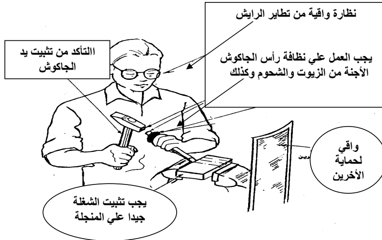
شكل ( 2 - 31 ) يوضح الاحتياطات الواجب توافرها قبل وأثناء عملية التأجين
