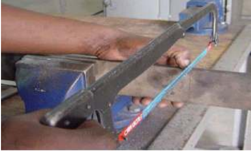
شكل ( 32-2 ج ) يبين الطريقة الصحيحة لأجراء عملية النشر
