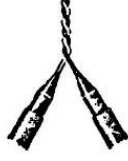
شكل ( 9-3 ) وصلة البوات ( زيل الفار )
