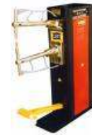
شكل ( 2 - 46 أ ) ماكينة لحام بالنقطة ثابتة تعمل بالقدم . شكل ( 2 - 46 ب ) ماكينة لحام بالنقطة متنقلة تعمل باليد.
