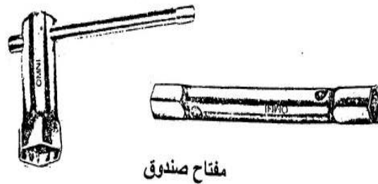
شكل ( 2 - 43 أ , ب ) يوضح المفتاح وطريقة استخدامه
