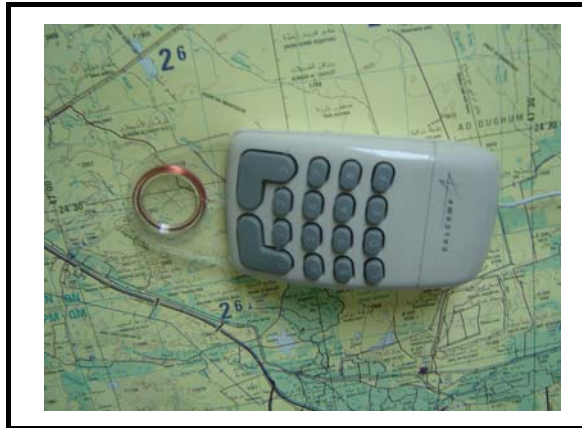
شكل (2 - 11): فأرة الترقيم متصلة بطاولة الترقيم.
