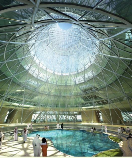
استخدام الحوائط الستارية والتي تعمل على توفير الاضاءة الطبيعية وبالتالي توفير الطاقة
