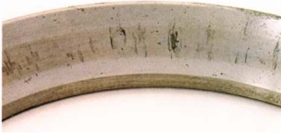
الحلقة الخارجية نتيجة التآكل بسبب الماء
