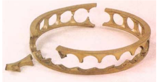
الحلقة القفصية للكرات نتيجة عدم التزيت
