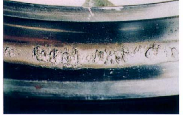
مسير حركة الكرات الحلقة الخارجية نتيجة قوى محوري زائدة
