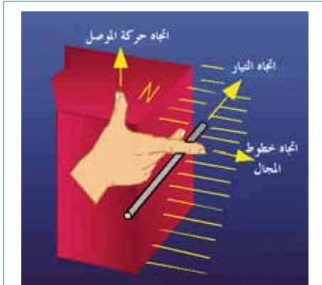
الشكل (١٩): قاعدة اليد اليمنى للمولد لتحديد اتجاه القوة الدافعة الكهربائية
