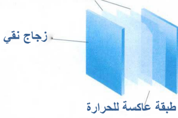
صورة توضح طبقات الزجاج المتعدد الطبقات
