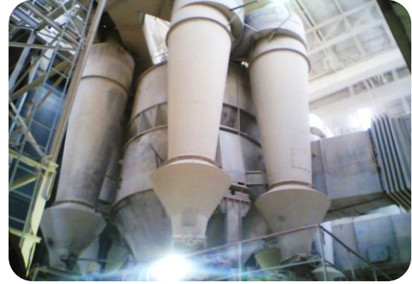
الشكل (5.5) : فارزة الإسمنت في المعمل .
