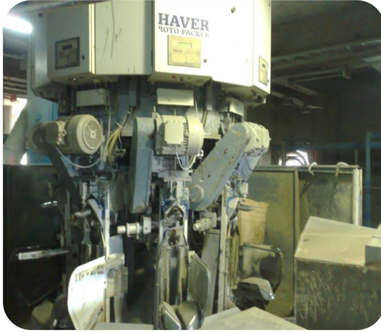
الشكل (6.6) : آلة تعبئة الإسمنت بثمانية عينيات .
