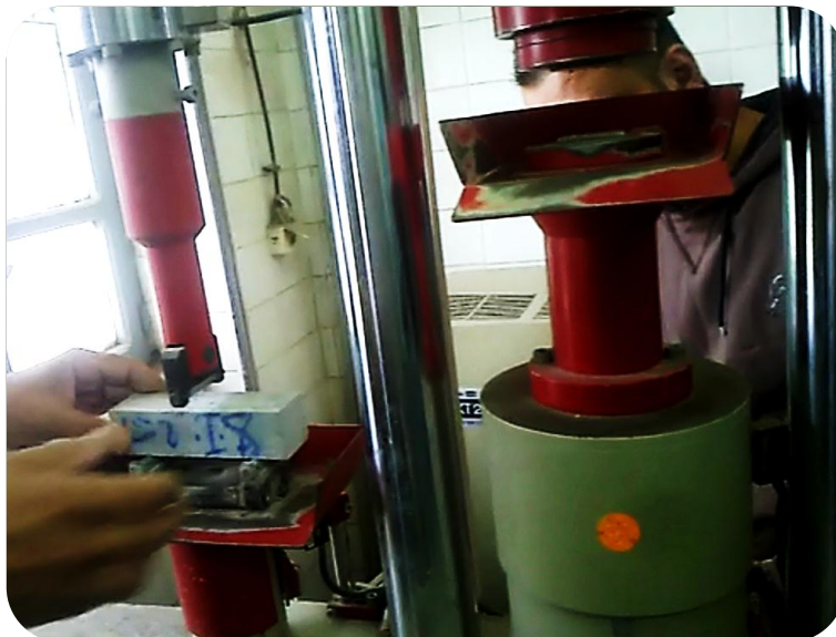
الشكل (2.9) : جهاز الضغط و الكسر .
