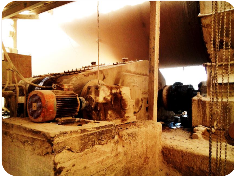
الشكل (5.3) : محرك و علبة سرعة مطحنة المواد الأولية .
