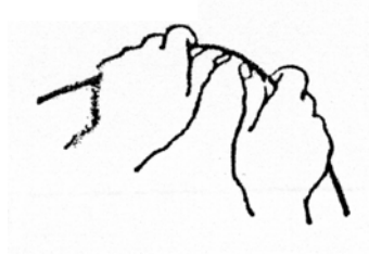
شكل رقم (١٢١) عملية ثني الموصل.
