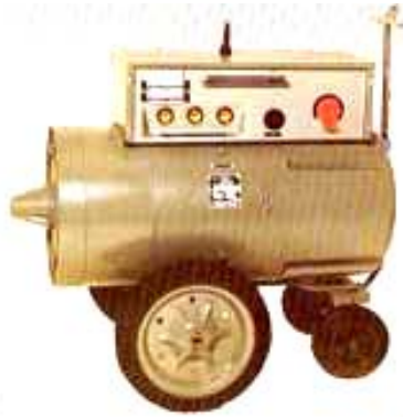
شكل رقم (٣٢) وحدة محرك - مولد متنقلة تعمل بالطاقة الكهربائية.
