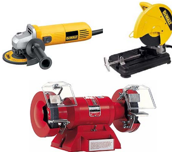
شكل رقم (٢٢) الأشكال المختلفة لحجر الجليخ الكهربائي.
