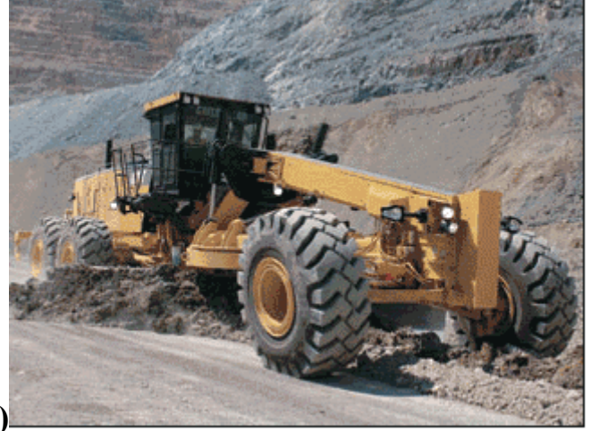
(شكل معدة القاصابية اثناء تسوية التربة)
