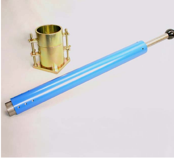
شكل (3.4): القالب القياسي لدمك التربة في المعمل
