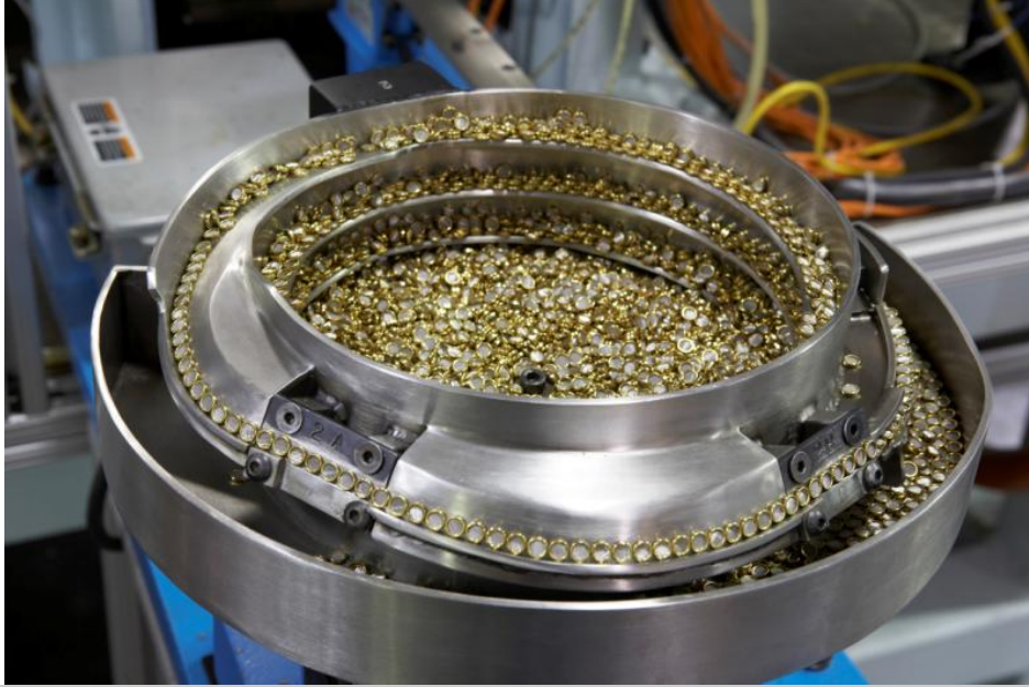
وعاء هزاز يقوم بترتيب القطعات الصغيرة في جهة معينة لتلقيها Vibratory Feeder Bowl
