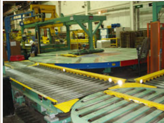
طاولة (إسطوانات متدرجة) دوارة لنقل القطعات يمكن تغيير جهة إستقرار القطعة عليها
