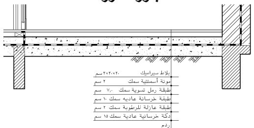
شكل رقم (١٣) الطبقة العازلة للرطوبة في حمام بدور بدروم
