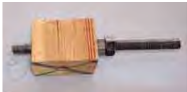
الشكل (٤-٣): قالب خشبي لتثبيت قالب المحول حوله قبل تركيبه على ماكينة اللف
