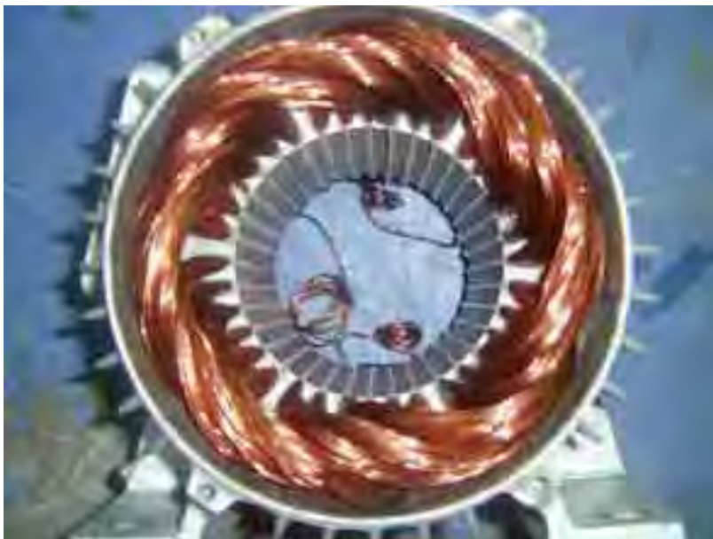
الشكل (٤-١٦): إسقاط جميع ملفات الأقطاب للأطوار والانتهاؤها منها جميعاً
