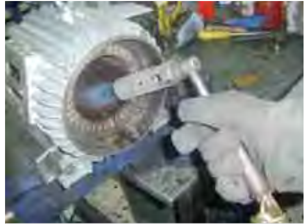
الشكل (٢-٩): طريقة التسخين لإزالة الملفات المحروقة باستخدام السشوار
