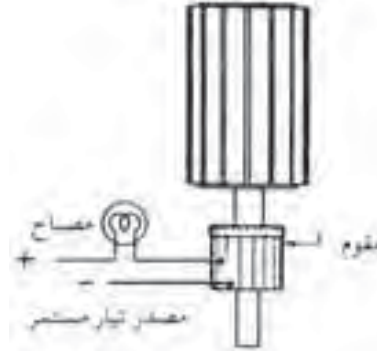
الشكل (٣-٣) : فحص التماس بين حلقات الموحد
