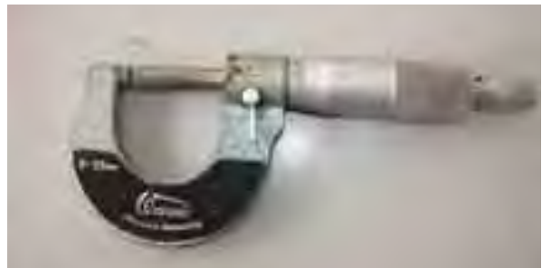
الشكل (٢-٣): جهاز الميكروميتر لقياس قطر سلك اللف
