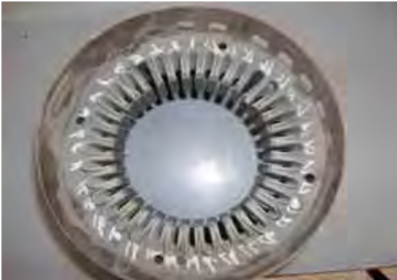
الشكل (٤-١٢): عزل المجاري بورق العزل البلاستيكي للتحضير لإسقاط الملفات
