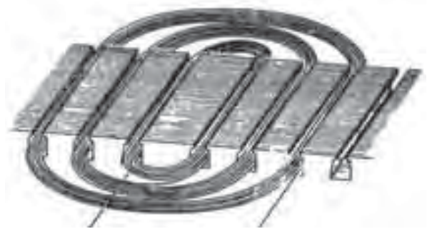
الشكل (١-٤) : اللف بطريقة اللف المتداخل (خطوة متغيرة)
