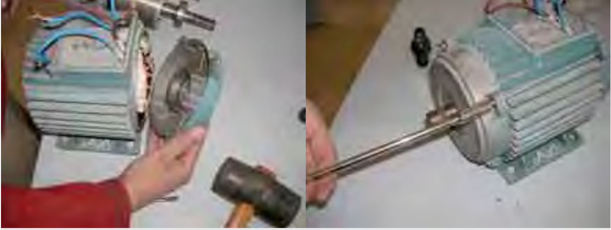
الشكل (٤-٢) : طريقة نزع أغطية المحرك أثناء عملية الفك
