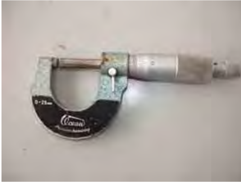
الشكل (٤-٨): قياس قطر سلك اللف بوساطة الميكروميتر
