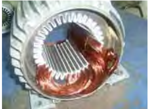
الشكل (٢-١٧): إسقاط ملفات التشغيل داخل مجاري المحرك
