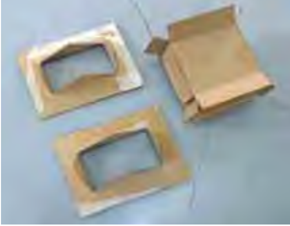
(أ) طريقة قص الإطار الخارجي للقلب المصنوع يدوياً (ب) الغلاف العلوي والسفلي لقلب المحول المصنوع يدوياً الشكل (٤-٣): طريقة عمل القلب الكرتوني اللازم لتثبيت الملفات والشرائح بداخله
