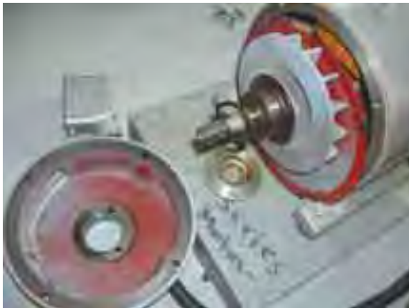
الشكل (١-٢): فك براغي تثبيت محرك تيار مستمر
