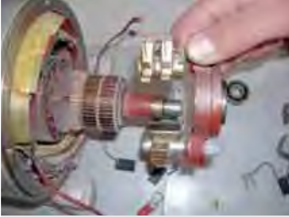
الشكل (٢-٣): فك وتجميع آلة تيار مستمر
