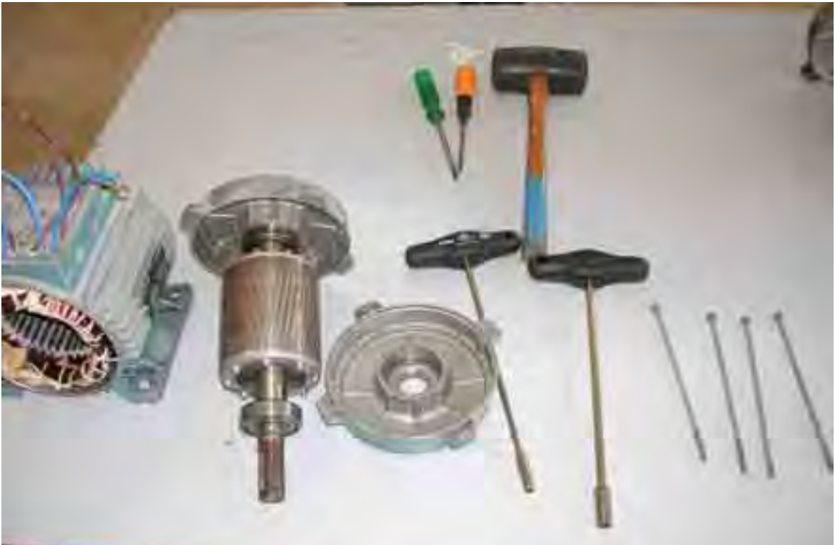
الشكل (٣-٣): أجزاء محرك ثلاثي الطور بعد الفك
