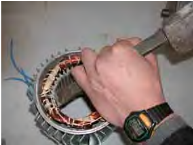
الشكل (٩-٤): طريقة قطع الملفات لإزالتها من المجاري
