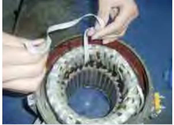
الشكل (٢-٢٣): تريبط كل من ملفات البدء وملفات التشغيل بشبر التريبط لعزلها وترتيبها داخل المحرك
