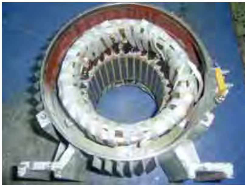
الشكل (٤-٢٠): ترتيب ملفات المحرك قبل تثبيت الأغطية الجانبية وأثناء التربيط
