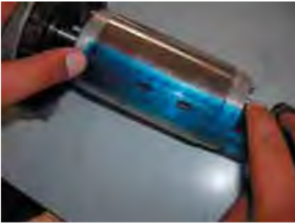
الشكل (٢-١٠): استخدام الكليبير (أو المسطرة) لقياس طول مجرى المحرك مع إضافة ٣ ملم من كل جانب (لقص ورق العزل البلاستيكي للمجاري)
