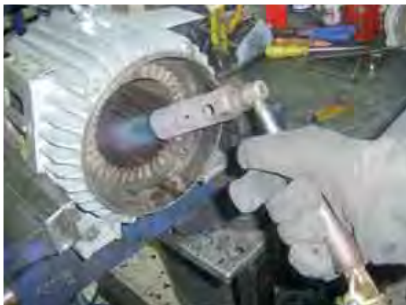
الشكل (١٠-٤): طريقة نزع الملفات من داخل المجاري
