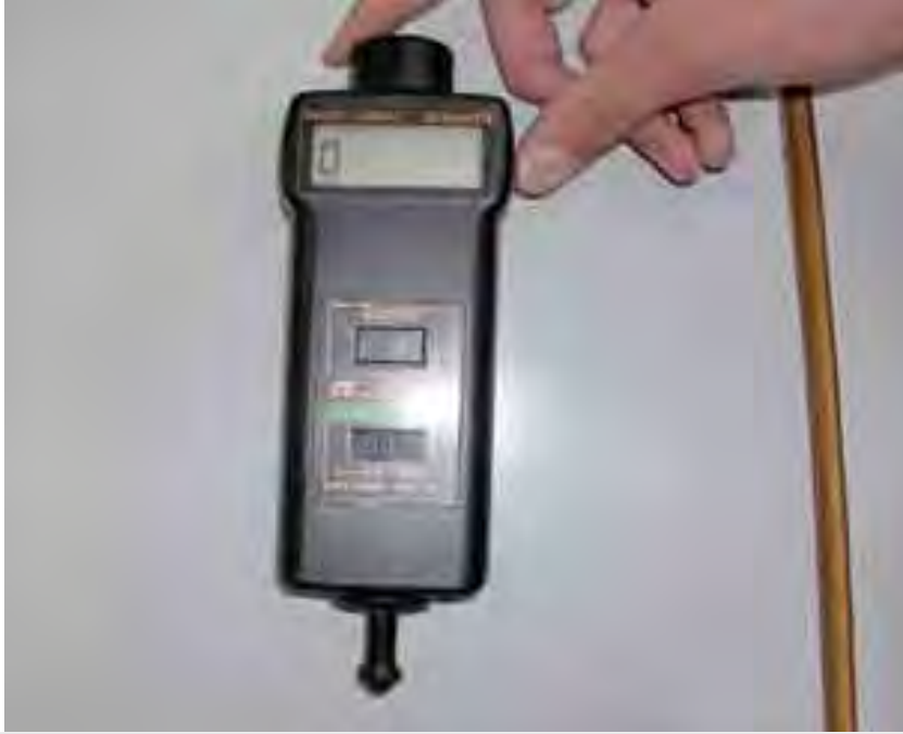
الشكل (٦-٣): جهاز قياس السرعة (التاكو ميتر)
