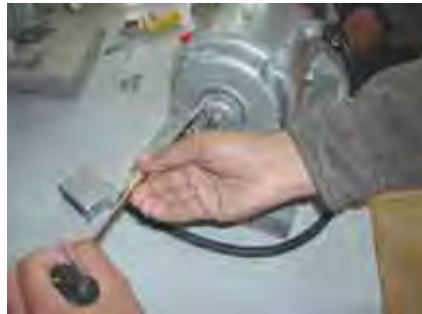
الشكل (١-٢): فك براغي تثبيت محرك تيار مستمر
