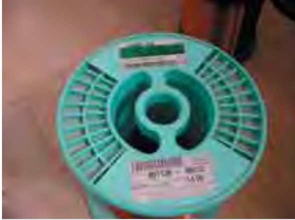
الشكل (٢-١٤): بكرة أسلاك لف المحركات (موضح عليها قطر السلك)
