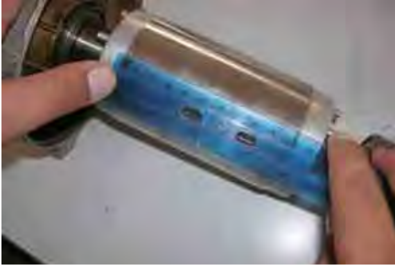
الشكل (٤-١١): أخذ قياس طول المجرى لقص ورق العزل البلاستيكي
