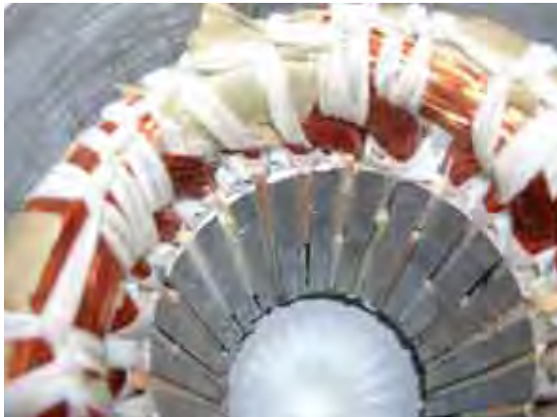
الشكل (٤-١٨): عزل ملفات الأطوار جميعها بورق العزل الكرتوني من الجهتين
