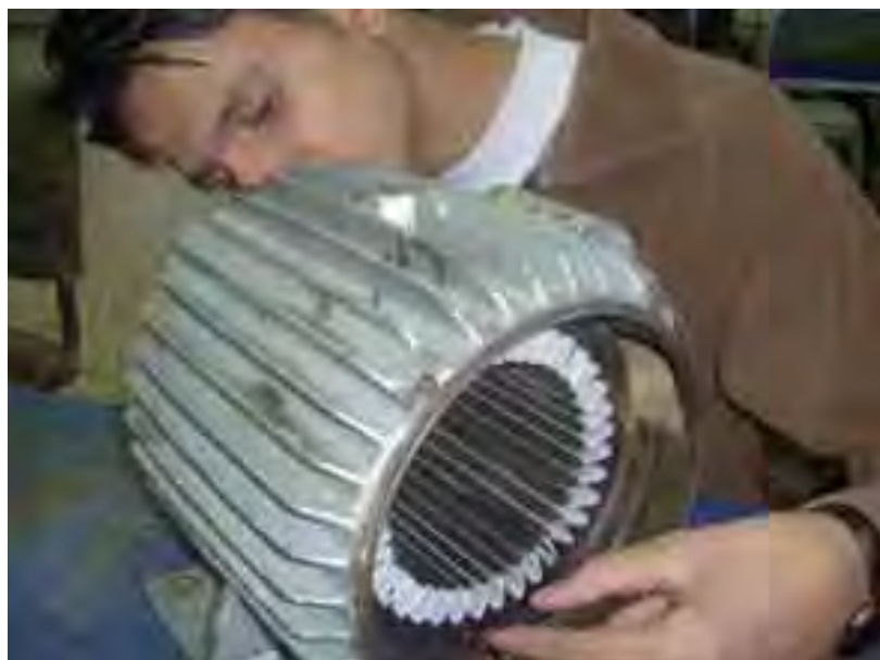
الشكل (٤-١٤): أخذ عينه (مقياس لف الملفات) على شبلونة اللف
