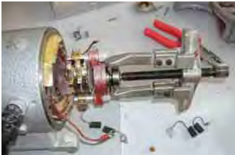
الشكل (١٠-٢): طريقة نزع كراسي التحميل التالفة لاستبدالها بأخرى صالحة باستخدام البريصة
