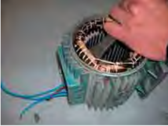
الشكل (٢-٨): طريقة قطع وإزالة ملفات محرك تالفه بالازميل والمطرقة
