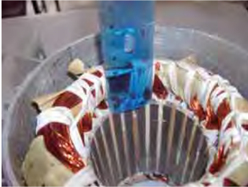
الشكل (٤-١٩): تربيط ملفات المحرك جميعها بشبر التربيط الخاص
