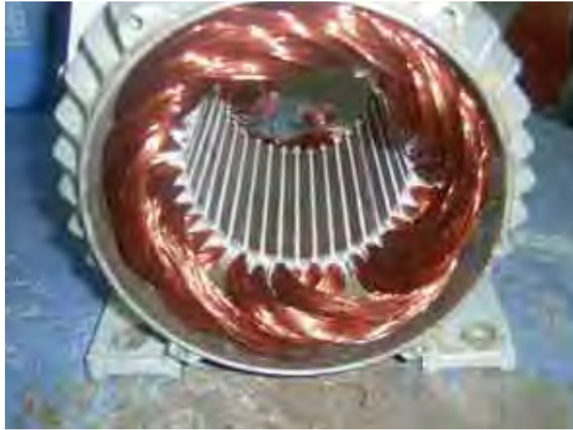
الشكل (٤-١٧): عزل مجاري المحرك بعد إسقاط الملفات فيها بورق العزل البلاستيكي
