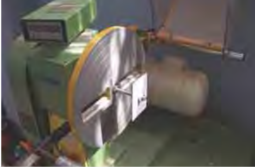
الشكل (١-٣): تعديل ماكينة لف المحركات لتصبح جاهزة للف المحولات الكهربائية
