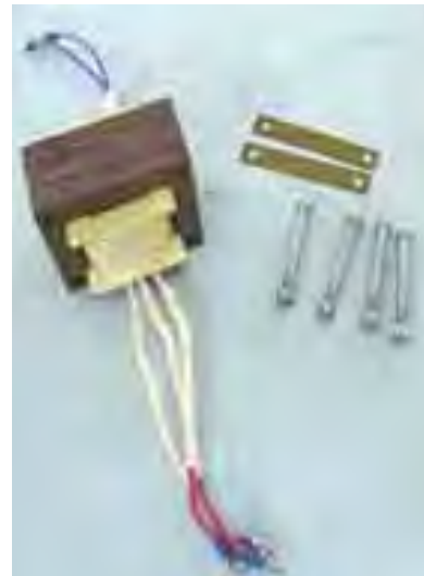
الشكل (٢-٢): فك براغي تثبيت هيكل المحول وسحب الصفائح الشكل (٢-٣): وضع شرائح المحول في مكان مناسب لحين التجميع الشكل (٢-٤): إعادة تركيب صفائح الحديد
