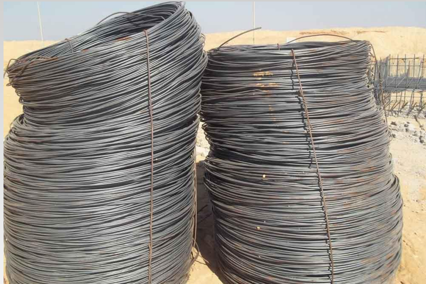
حديد املس الربطة يتم فكها وعمل عملية تحريب
