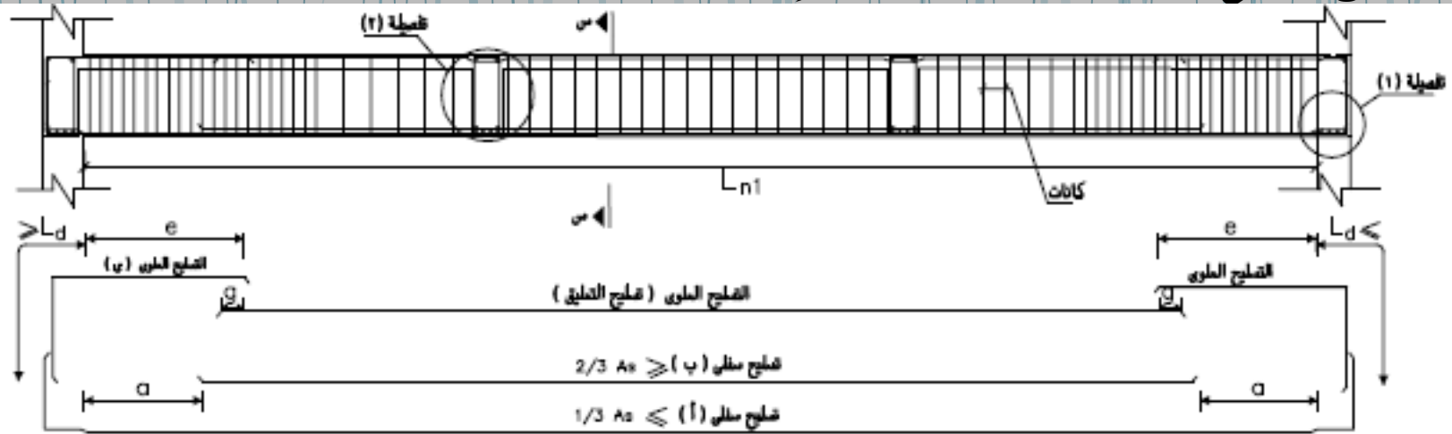
تفصيلة نموذجية في كمر بسيطة الارتكاز (Panelled Beams)
