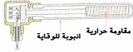
تركيب ترمومتر المقاومة
