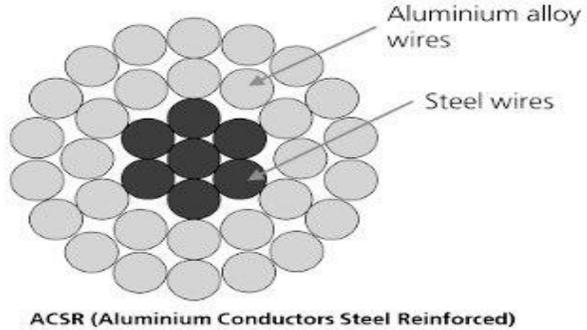
2- الألمنيوم المقوى بالحديد الصلب Aluminum Conductor Steel Reinforced ACSR هذا الموصل
