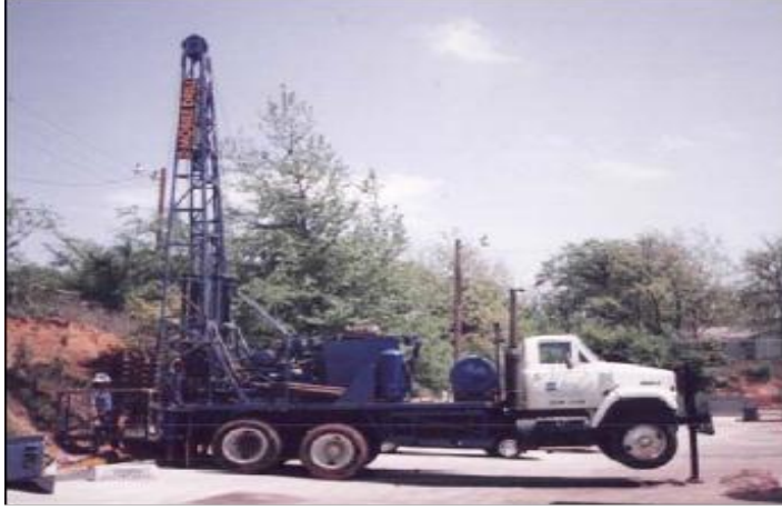
الصورة (٣-٢) توضح عمل الجسات ميكانيكياً (الإنترنت)
