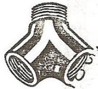
مثلث أو وصله سياميز double connection Siamese connection
