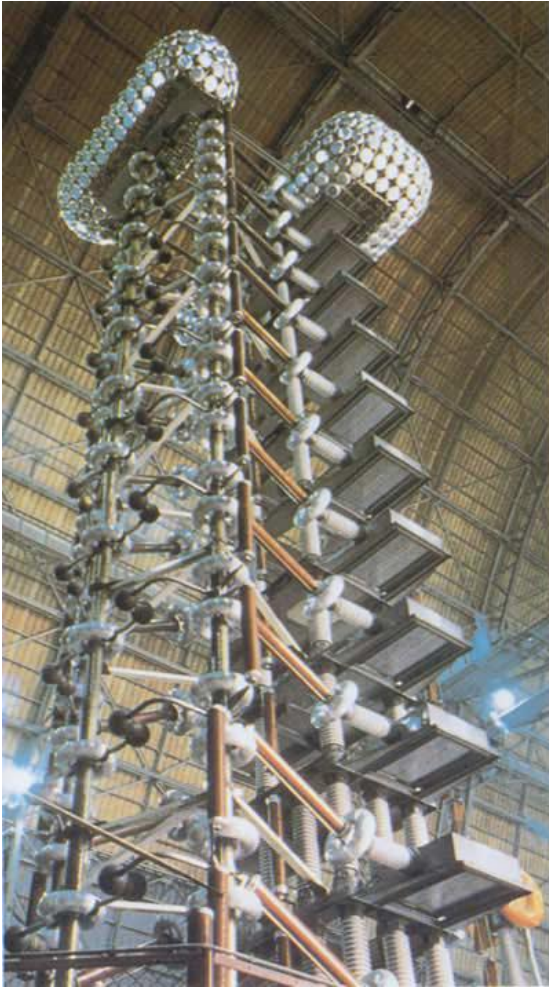
شكل 14-6 : شكل ال Surge Generator
