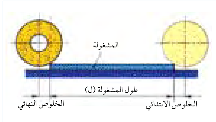
شكل (٤-٣٨) طول الشوط في التجليخ المحيطي
