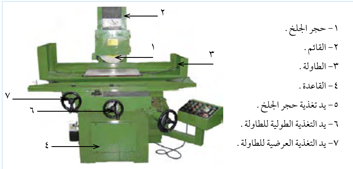
شكل (٤-٢) الأجزاء الرئيسية لآلة الجليخ المستوي الأفقية
