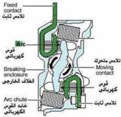
Roto-active breaking: repulsion of contacts فصل الدارة يتم بواسطة تناثر التلامسات
