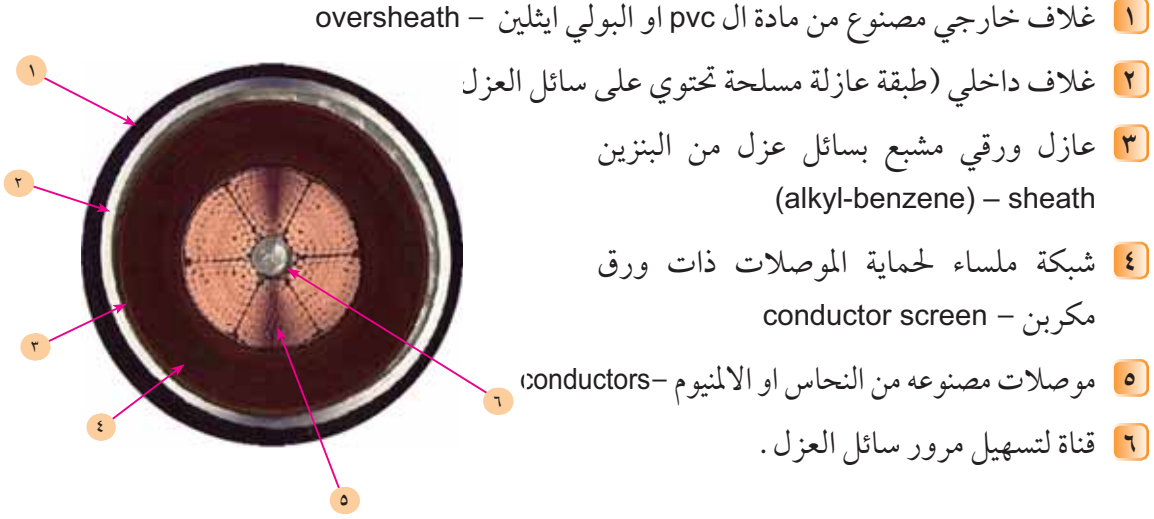
الشكل (٢-٥) : مقطع عرضي لكيبل ورقي
