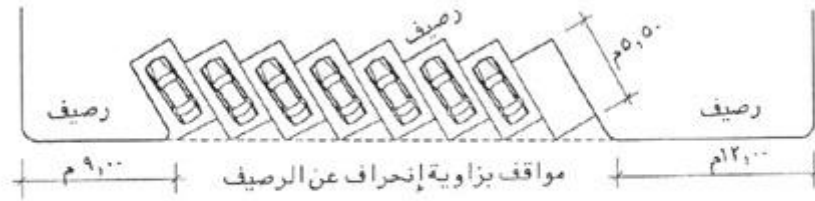
شكل رقم (٣) الحد الأدنى لبعث المواقف المائلة عن تقاطعات الطرق
