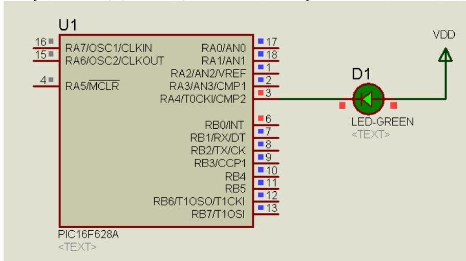
حدثت المفاجأة وعمل الـ LED بشكل سليم . قامت بقياس فرق الجهد بين هذا الطرف وبين الجهد الموجب فوجدت أنه خمسة فولت وهذا يعني أن هذا الطرف جهده أصبح صفر .
