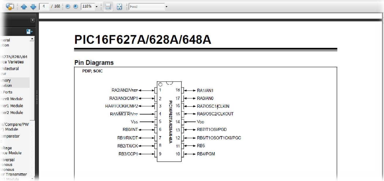
إذا قمنا بتكبير الرسمة ستبدو لنا كما في الشكل بأسفل الصفحة حيث نجد الميكروكنترولر مكتوب عليه PIC16f627a, PIC16f628a, PIC16f648 أي أن هذه الثلاثة أنواع لها نفس أسماء الأطراف . دقق النظر مرة أخرى ستلاحظ أن الأطراف التي نستطيع توصيل المذبذب بها هي الأطراف رقم 16 و 15 **كيف عرفت ؟** لأنه مكتوب بجوارهم OSC1 , OSC2 . والآن قارن بين هذين الطرفين وبين نظائرها في الـ PIC16f84a **ماذا تلاحظ ؟؟**
