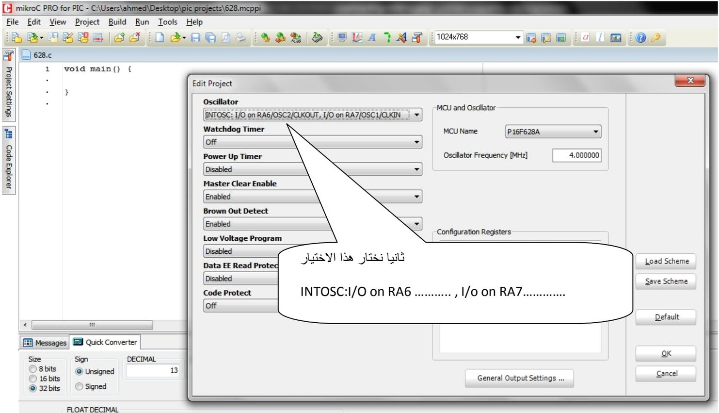
من قائمة project نختار edit project ثم نختار نوع الـ PIC والتردد ثم نضغط بالماوس على Default ثم نختار INTOSC: I/O on RA6/OSC2/CLKOUT , I/O on RA7/OSC2/CLKIN
