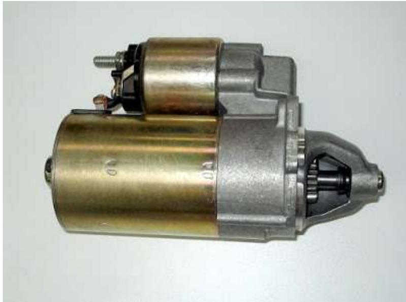
يقوم نظام بدأ تشغيل محرك السيارة او محرك المولد بتحويل الطاقة الكهربائية والتي تأتي من البطارية الى طاقة ميكانيكية وذلك من أجل ادارة المحرك
