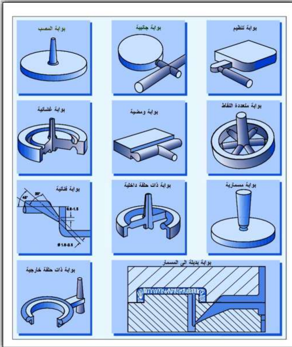
شكل (3-5) أنواع البوابات المستخدمة في قولبة اللدائن.
