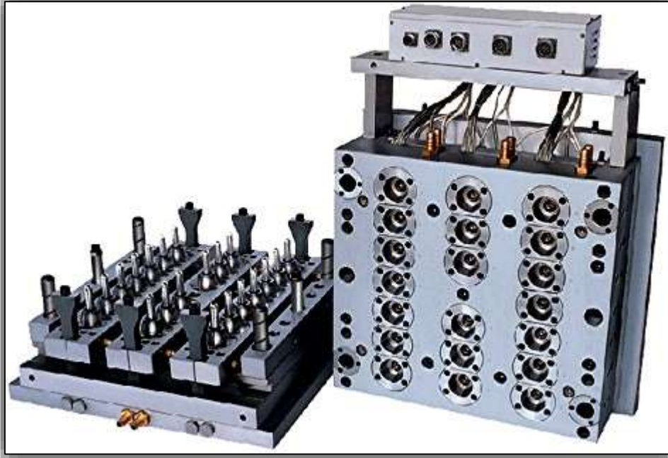
شكل (3-9) قالب مصنوع من الصلب ذو منتجات متعددة.
