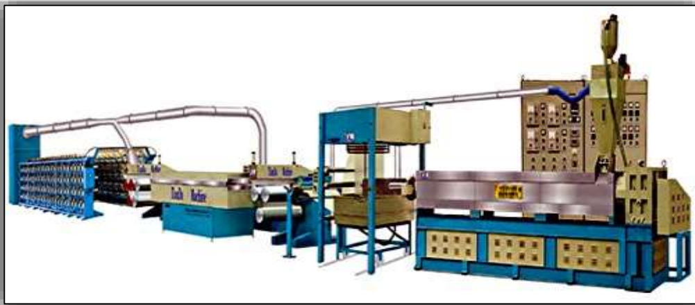
شكل (2-29) آلة بثق لصنع الحبال اللدائنية.
