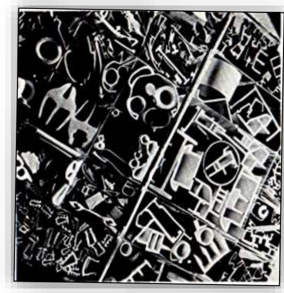
شكل (2-10) أشكال متنوعة لمنتجات تم الحصول عليها بالقولبة بالبتق.
