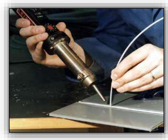
شكل(9-1) طريقة اللحام اليدوية لللدائن بالغاز الساخن .
