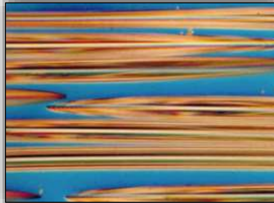
شكل(14-13) بنية مجهرية لمادة مركبة مقواة بالألياف المستمرة (الطويلة).
